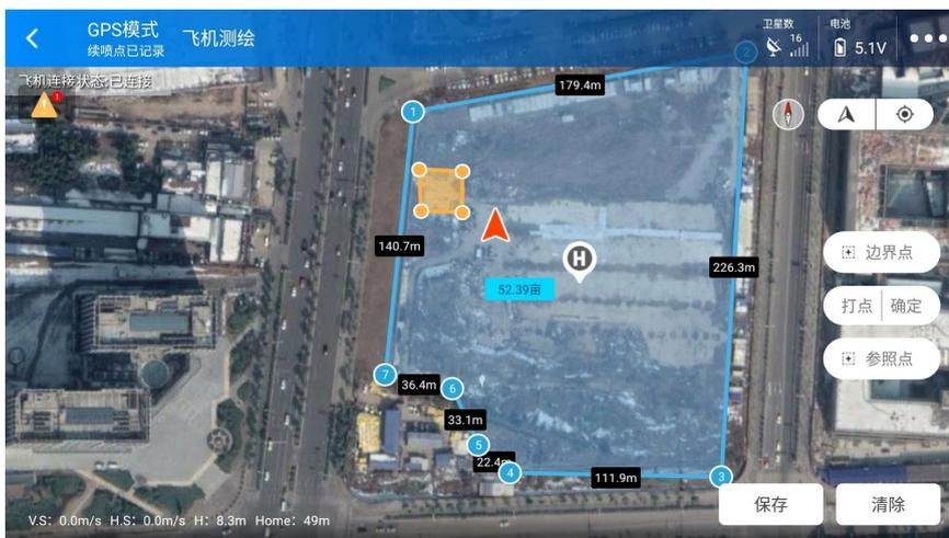
选择【多边形障碍点】后，障碍点按钮会变为【打点】和【确定】两个按钮
