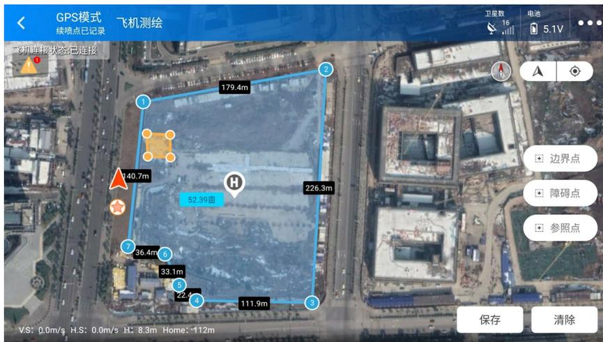
参照点用于纠正因打点器与飞行器、RTK定位差异所引起的航线偏差。在作业区域附近的开阔位置，选择一个长期固定存在且易于辨识的参照物作为标定点，如地钉或其他明显的标记物，以便在同一地块地块任务时可以迅速准确地纠正偏移。
