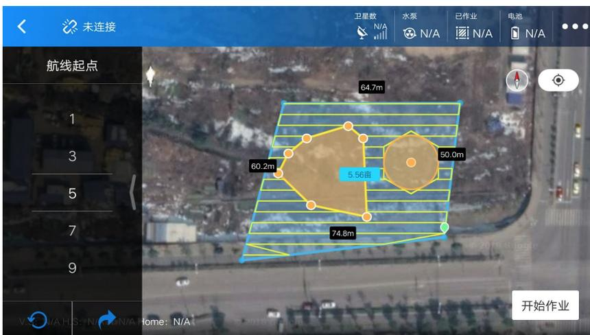
在作业界面中，可以调整飞机飞行航点，对飞行过程中是否跳过断点进行自由选择。点击左侧
