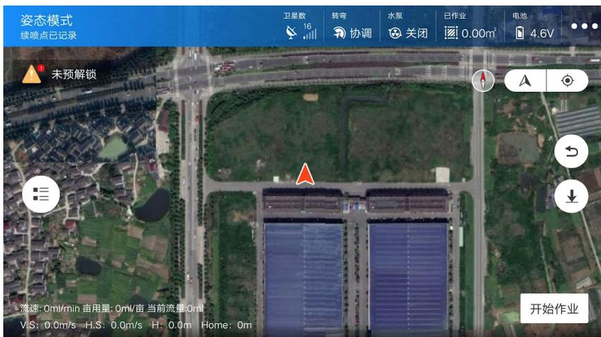
AB点作业：通过遥控器绘制A点和B点，并切换到AB点模式，选择航行方向执行AB点作业。
